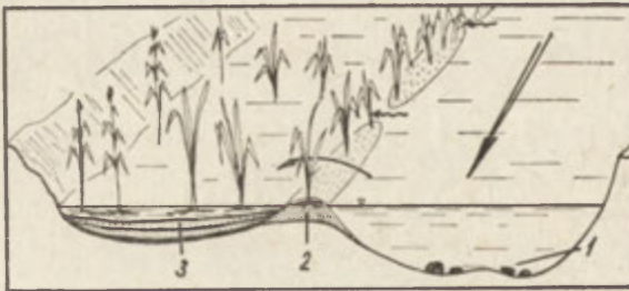
Ryc. 2. Dwudzielność koryta wywołana zarastaniem roślinnością przybrzeżną. 1 — osad bruku korytowego, 2 — osad wału korytowego, 3 — zawieszinowo-organiczne osady wód okresowo stagujących
