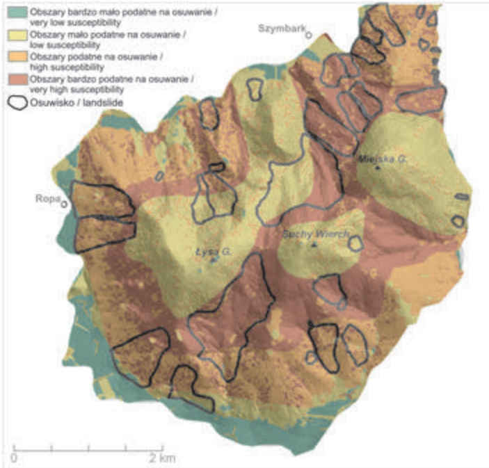
Ryc. 34. Mapa podatności na osuwanie z zasięgiem osuwisk. Obszar badawczy – Beskid Niski Landslide susceptibility map with landslide range. Study area in the Beskid Niski Mts.
