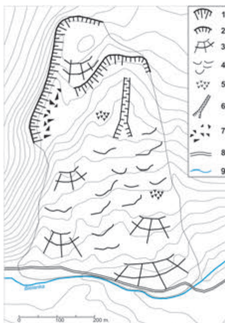
Ryc. 15. Plan osuwiska Hucisko (S6) w Beskidzie Niskim. 1 – skarpa osuwiska pow. 20 m, 2 – skarpa osuwiska do 20 m, 3 – większe wały i nabrzmienia koluwalne, 4 – wyrównane powierzchnie osuwiska, 5 – wysięki wód, 6 – rozcięcia erozyjne, 7 – rumowisko, 8 – droga, 9 – ciek
