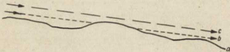
Ryc. 8. Schemat wyjaśniający konsekwencje progów na trasie odpływu; a — linia przekroju powierzchni dennej, b — zwierciadło wód niskich, c — zwierciadło wód wysokich
