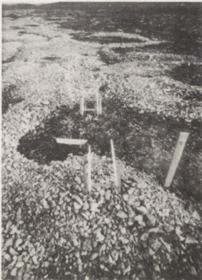
Fot. 4. Stanowisko termometrów zainstalowanych w gruntach modelowanych w Revdalen (wrzesień 1979)
