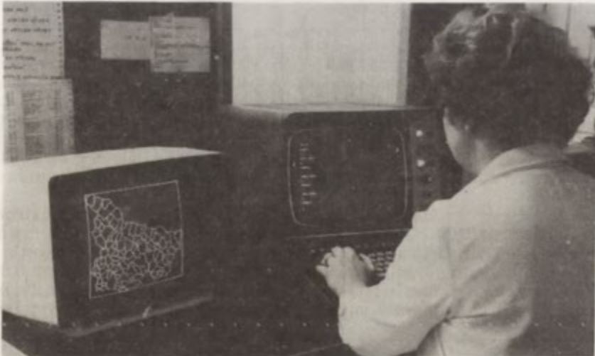
Fot. 4. Monitor graficzny (z lewej) i monitor alfanumeryczny (z prawej) komputera ADT 4500. Operatorka przeprowadza kontrolę i korekcję obrazu cyfrowego mapy podziału katastralnego powiatu Humenné w woj. wschodniosłowackim.
