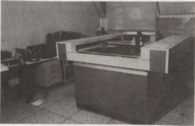
Fot. 5. Zestaw kreślący DIGIGRAF 1208. Na pierwszym planie stół kreślarski. Za stołem (częściowo zasłonięta) jednostka pamięci taśmowej.
