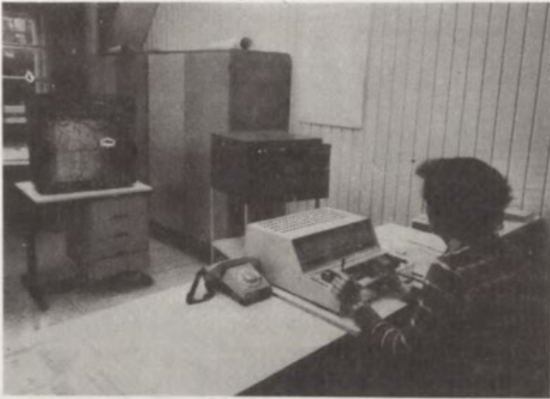
Fot. 3. DIGIPOS 1208: na pierwszym planie pulpit sterujący systemem. Operatorka naprowadza celownik kamery telewizyjnej na wybrany punkt za pomocą manipulatora drążkowego. Na monitorze telewizyjnym jest przedstawiony w znacznym powiększeniu obraz pochodzący z kamery. W górnej części monitora wyświetlane są współrzędne punktu, na który naprowadza się celownik kamery. Celownik widoczny jako dwa prostopadłe odcinki znajduje się na środku ekranu. Na prawo od monitora stoi jednostka pamięci taśmowej.
