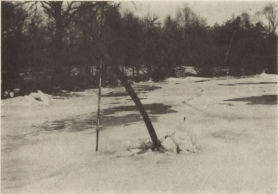
Fot. 5. Lata wodowskazowa zniszczona w wyniku naporu lodu (fot. P. Gierszewski) Water-level indicator destroyed by ice pressure (photo: P. Gierszewski)
