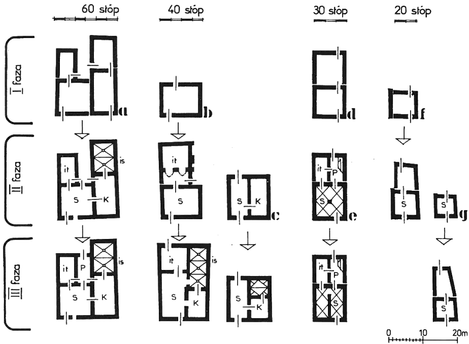
1. Fazy rozwojowe kamienicy wrocławskiej o różnych szerokościach (60–20 stóp), schematyczne rzuty parterów. Oznaczenia: S – sień; K – kantor; P – przechód; is – izba sklepiona; it – izba tylna. Zaznaczone sklepienia.
