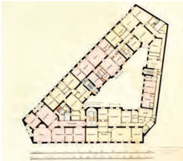
H. Projekt kamienicy przy ul. Wróblej 9 [?], arch. W. Marconi, 1902 r. Rzut czwartego piętra z podziałem na apartamenty. Zwraca uwagę nieco inny podział na lokale niż na piętrach bardziej prestiżowych (niższych). Tutaj wydzielono dodatkowe dwa mniejsze lokale z dwóch największych apartamentów (w tym jedno nieduże mieszkanko typu „oficynowego”).
