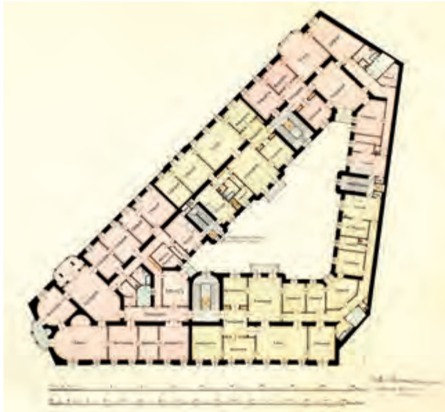
G. Projekt kamienicy przy ul. Wróblej 9 [?], arch. W. Marconi, 1902 r. Rzut pierwszego piętra z podziałem na apartamenty. Rzadki przypadek kamienicy narożnej o ostrym narożniku. Dwie dwutraktowe części budynku sąsiadują z ulicą, a część jednoraktowa od strony sąsiedniej działki ma charakter oficyny (są tam pomieszczenia gospodarcze dwóch apartamentów). Kształt budynku wymusił lokalizację większości sypialni od strony frontowej. Tylko jeden z trzech pokoiów berlińskich miał funkcję stołowego.
