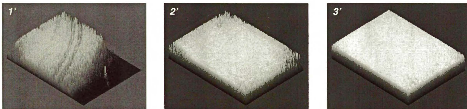
Rysunek 4.1.4.11. Zdjęcia (a) dwuwymiarowe i (b) pseudotrójwymiarowe BAM warstwy Langmuira adduktu C_{60}ur naniesionego na subfazę 1,81 mM adenozy, wykonane przy ciśnieniu powierzchniowym (1) i (1') 0, (2) i (2') 5 oraz (3) i (3') 15 mN m^{-1} ; rozdzielczość 20 \mu m .
