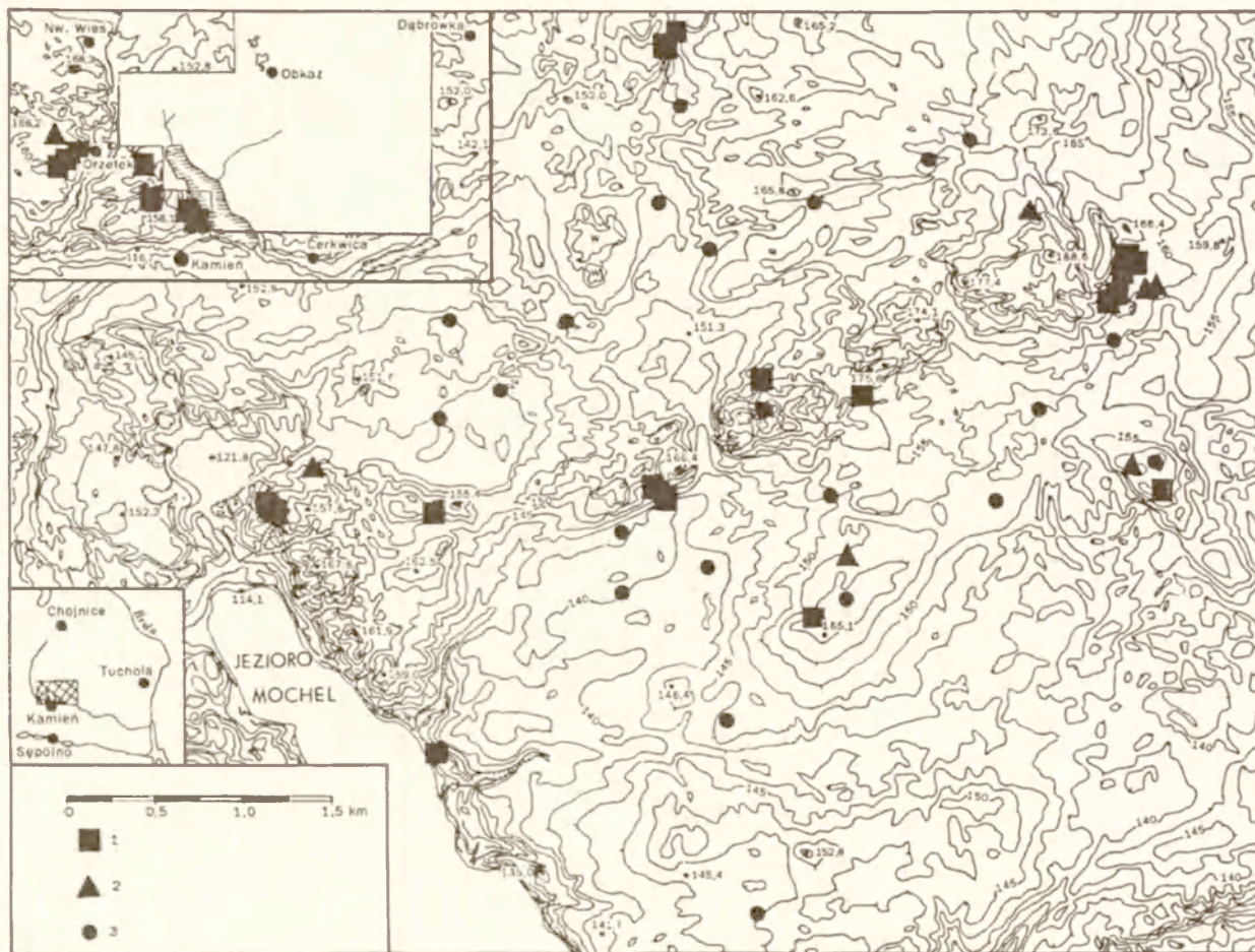
Ryc. 2. Obkaszka morena czołowa — mapa hipsometryczna 1 — odstonięcia i wkopy, 2 — pomiary strukturalne w osadach gliniastych, 3 — sondy geologiczne
