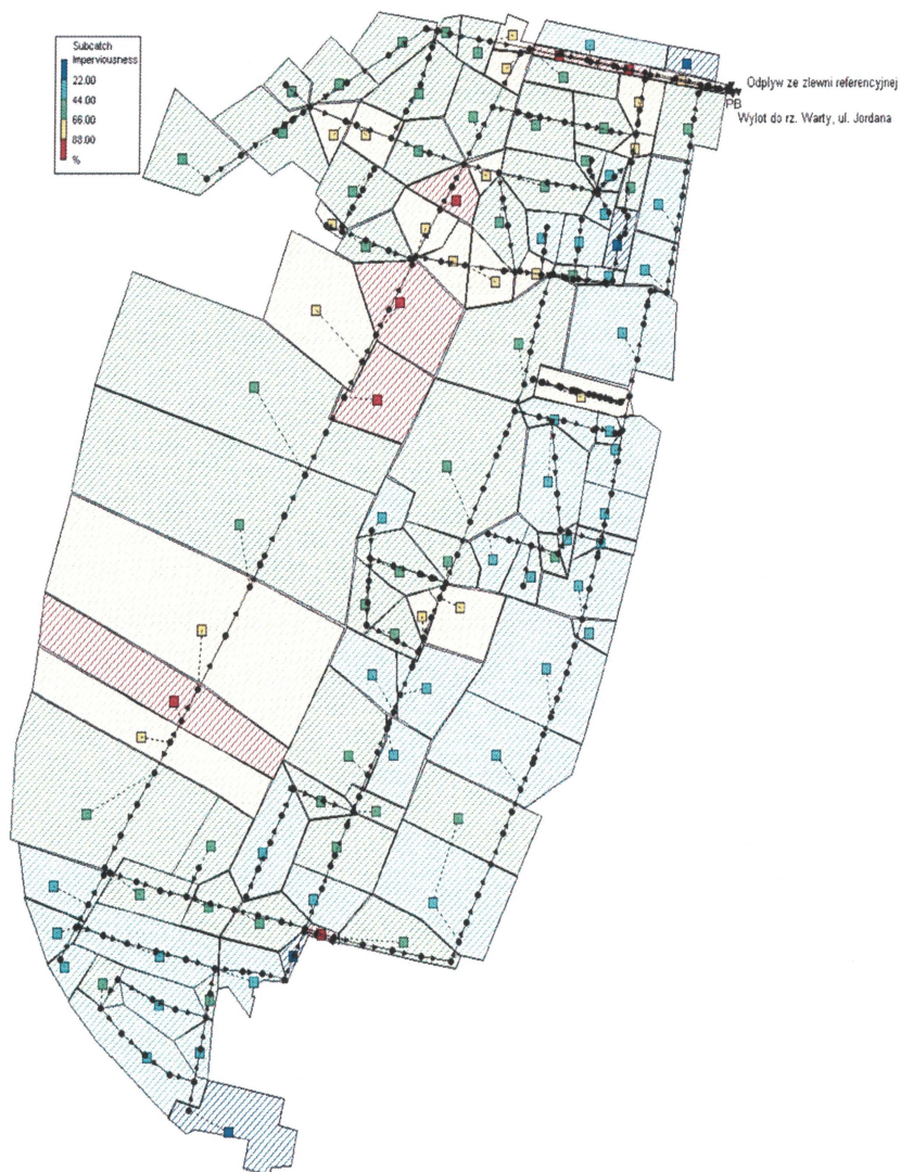
Rys. 6. Zlewnia referencyjna – podział na powierzchnie przepuszczalne.
