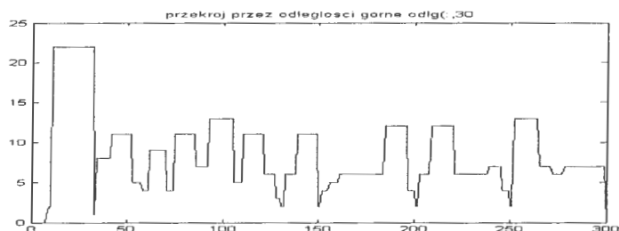
Rysunek 55 Odległości wyznaczone dla progu odcięcia 2% wartości maksymalnej dla całej macierzy detali dla wielkości cegieł dla ściany z rys. 40.
