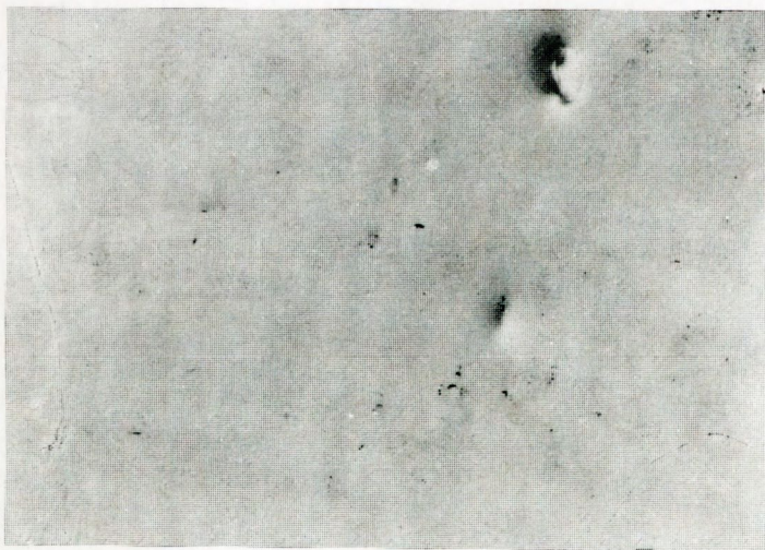
Fot. 3. Pojedyncze defekty typu BSF w płytce po zdjęciu warstwy o grubości 0,6 mm w roztworze MT3 (po selektywnym trawieniu w "Sirtl"). Pow. 50x
