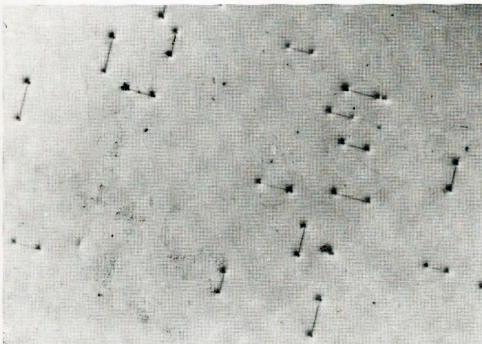
Fot. 2. Obraz defektów OISF na powierzchni płytki po obróbce termicznej w 1150°C w ciągu 4 h (po selektywnym trawieniu w mieszanke "Sirtl"). Pow. 50x
