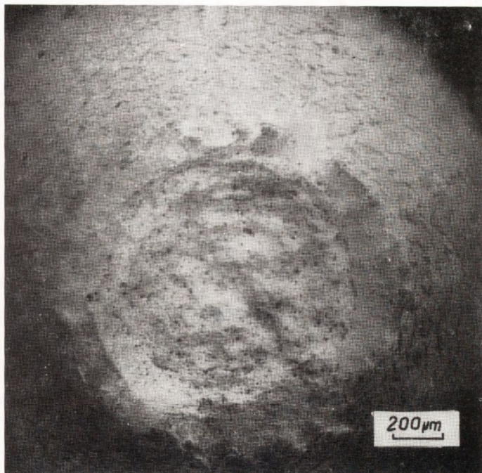
Rys. 3. Przełom próbki drutu, wytworzonego w ITME, powstały w próbie rozciągania
