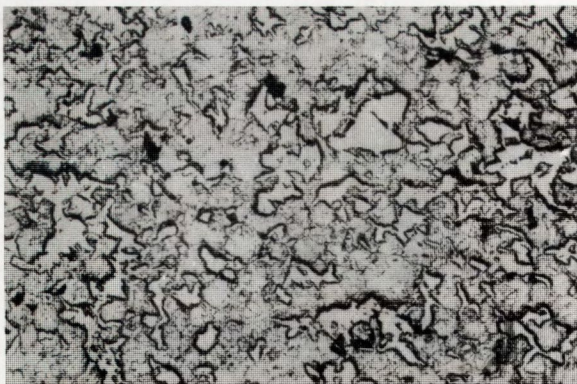
Rys. 8. Mikrostruktura kompozytu Cu+25%Cr po HIP; 50x
