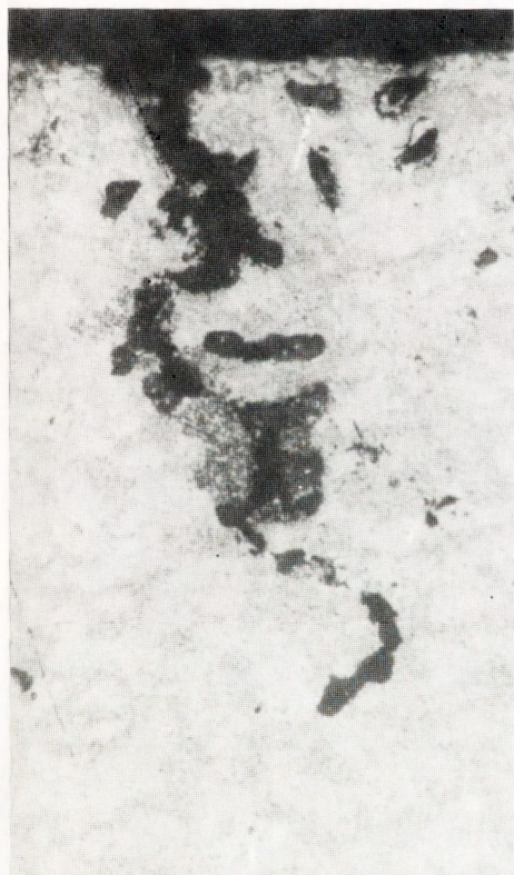
Rys. 2a. Ślady po lokalnym przegrzaniu w punkcie styczności. Nietrawione. Powiększenie 250x
