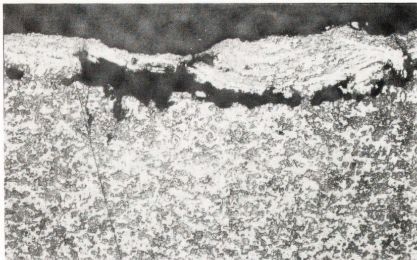
Rys. 1. Struktura nakładki stykowej W-Cu 30 Sb po próbie trwałości łączeniowej w styczniku próżniowym SV-7 Nietrawione. Powiększenie 50x
