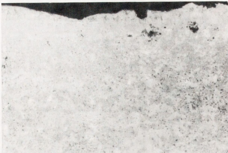
Rys. 6a. Warstwa przetopionego W na niepracującej części powierzchni roboczej styku stałego. Nietrawione. Powiększenie 250x
