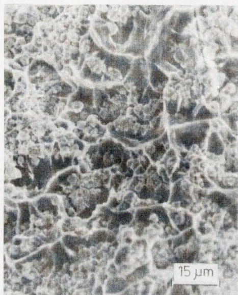
Rys. 6. Przełom szkieletu wolframowego nasyconego stopem CuSi 2
