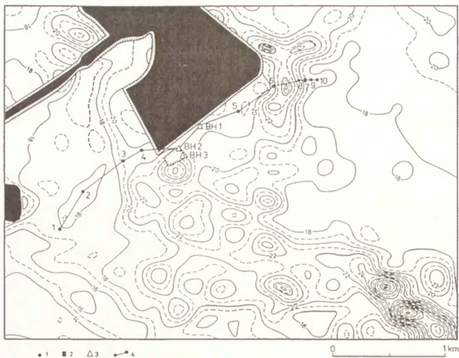
Ryc. 2. Mapa hipsometryczna obszaru badań (na podstawie Hoogtekaart van Nederland No 52 E noord, Meerlo ) i lokalizacja punktów badawczych. 1 — wiercenia, 2 — odsłonięcia, 3 — wkop, 4 — linia przekroju geologicznego.
