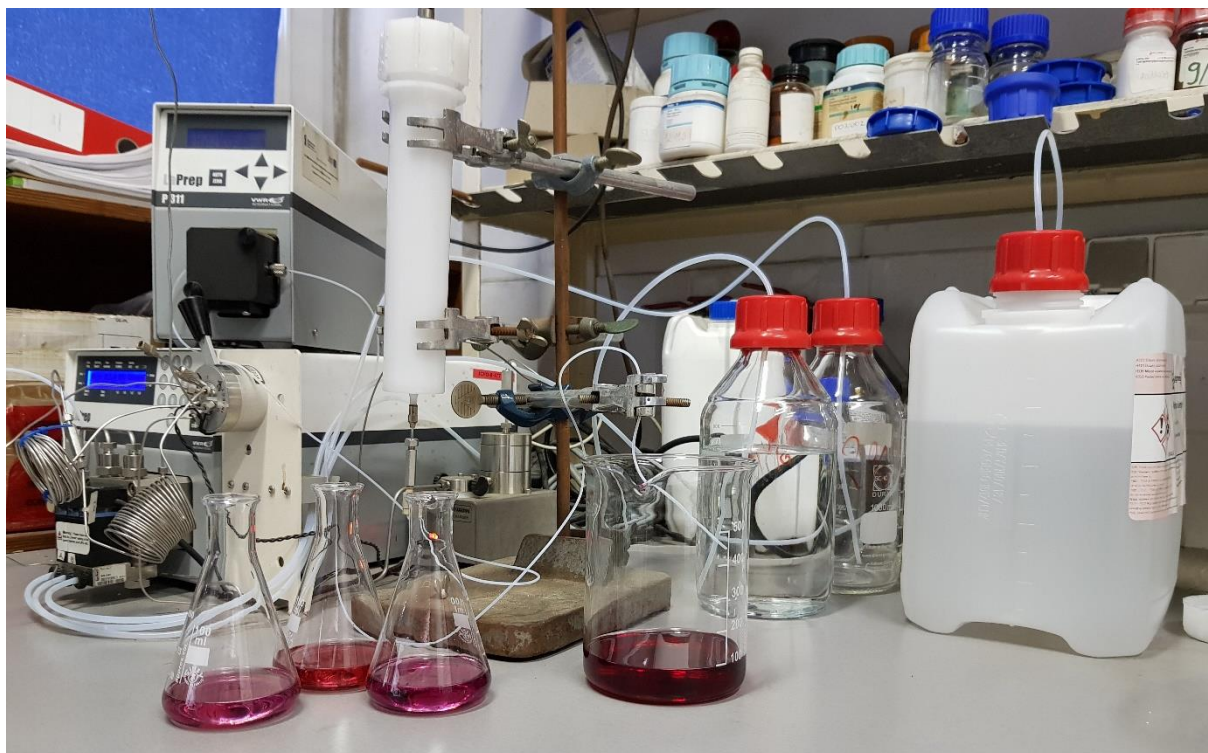
Rysunek 5.1 Aparatura stosowana do rozdziału chromatograficznego z udziałem wysokosprawnej pompy oraz detektora
