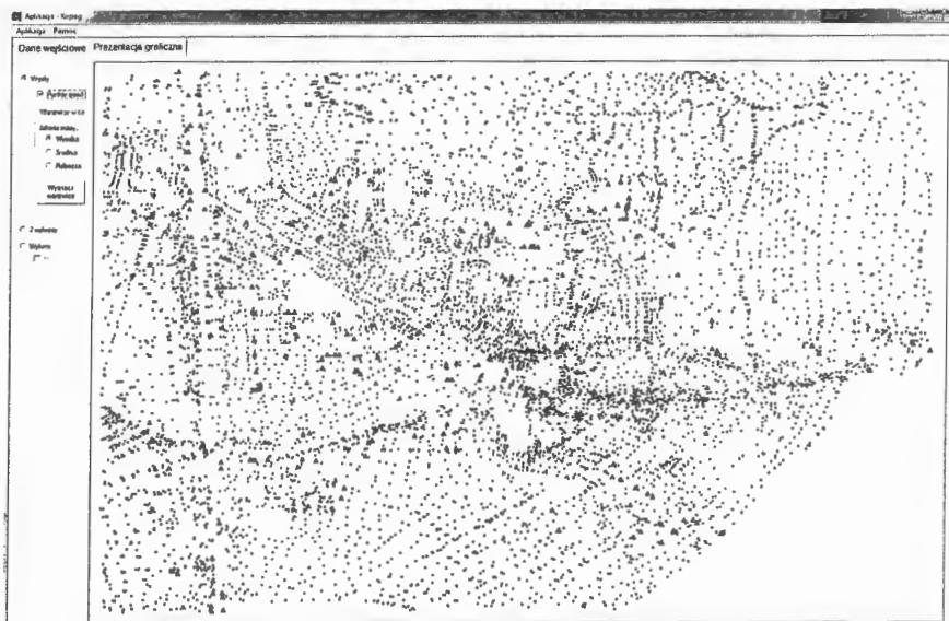
Rys. 9. Ekran programu Kripog: punkty węzłowe sieci wodociągowej na tle miejskich punktów geodezyjnych.
