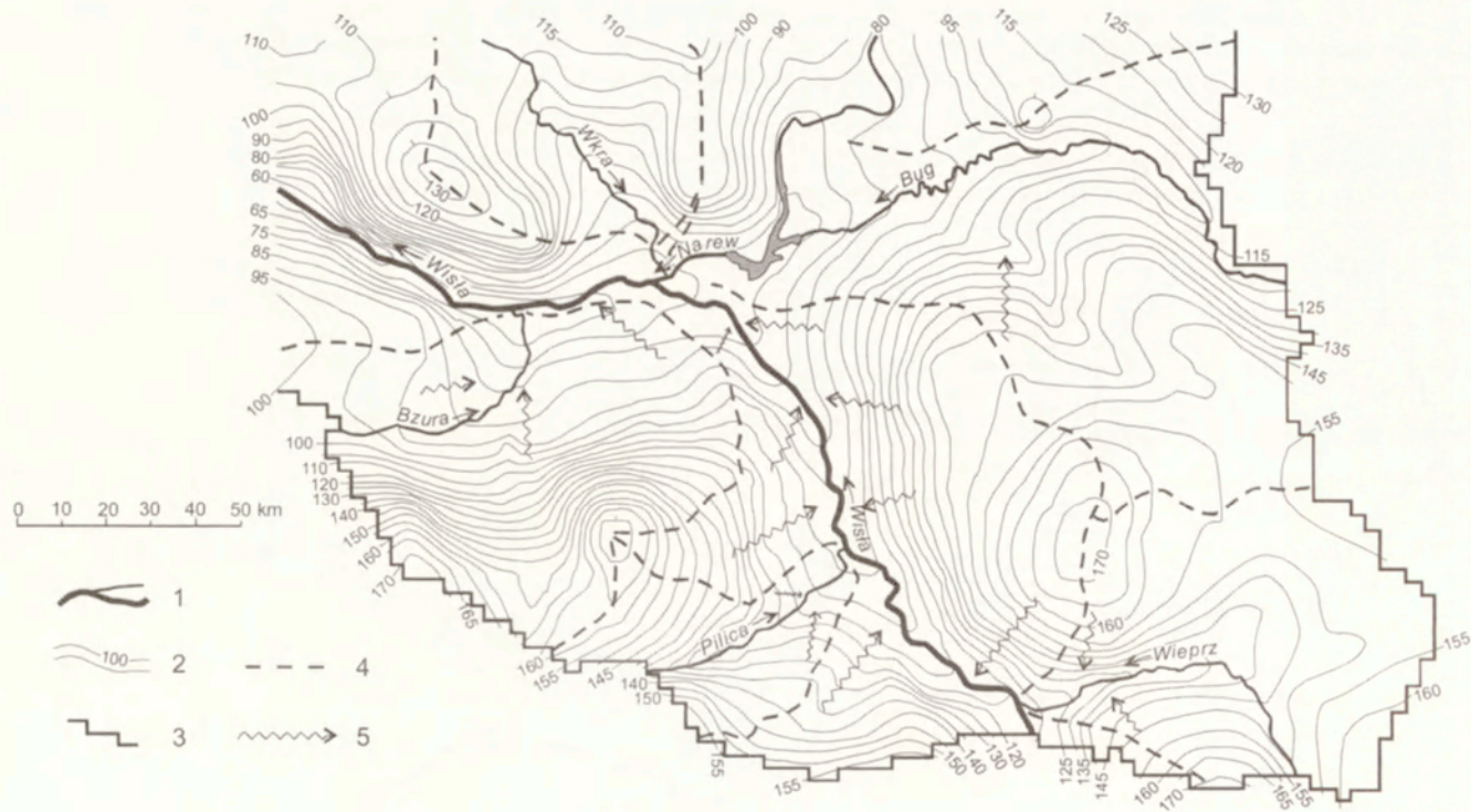
Ryc. 3. Hydroizohipsy czwartorzędowego poziomu wodonośnego Niecki Mazowieckiej w latach 1990–1992 (wg T. Macioszczyka, 1997, uzupełnione) 1 – rzeki; 2 – hydroizohipsy (w m nad poziom morza) wód freatycznych; 3 – granica zasięgu modelu hydrogeologicznego (wg T. Macioszczyka); 4 – prawdopodobne zasięgi zlewni podziemnych; 5 – kierunek odpływu wód podziemnych
