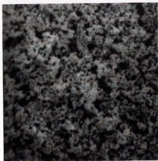
Rys. 10. Rozkłady uziarnień proszków wolframu 1 i 2. Obrazy z mikroskopu skaningowego proszków wolframu 1, 2, 1/A i 2/A /powiększenie 3000x/ http://rcin.org.pl
